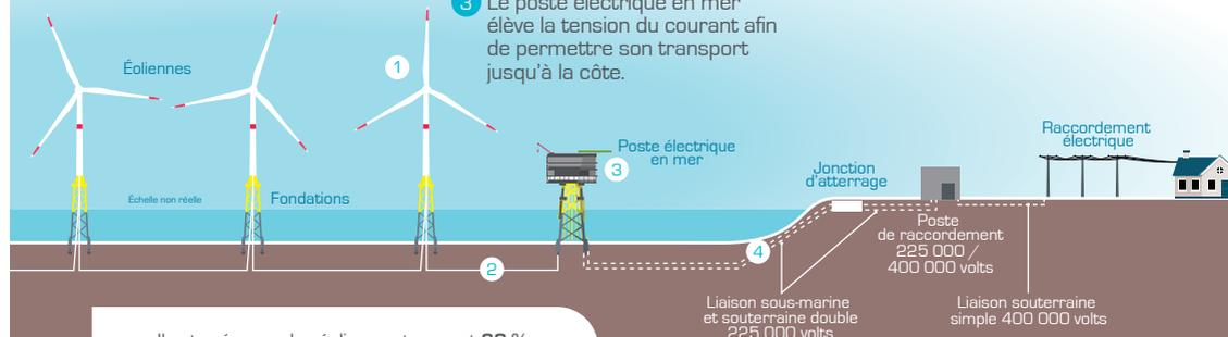
Il est prévu que les éoliennes tournent 90 % du temps, pour une production annuelle équivalente à un fonctionnement à pleine puissance 40 % du temps.
